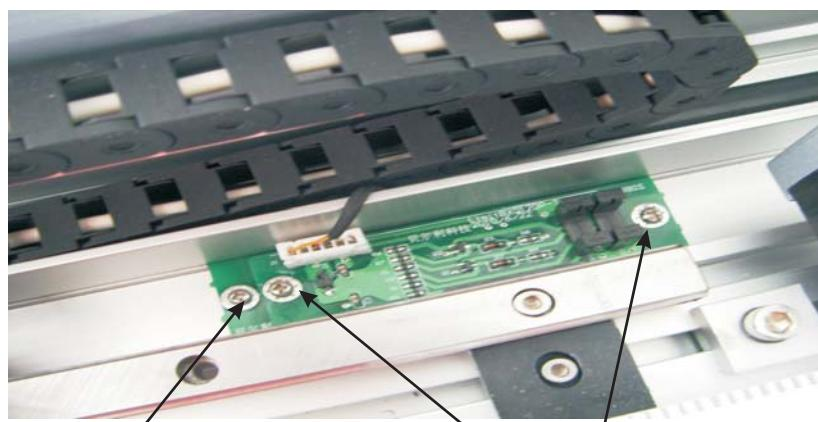
此处两个螺丝固定电路板，更换时只需松开这两个螺丝即可
